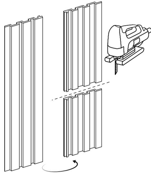
Los paneles se pueden montar en vertical, horizontal y en diagonal. Si quieres recortarlos, usa una sierra de mano, una sierra de calar o una sierra de mesa.
