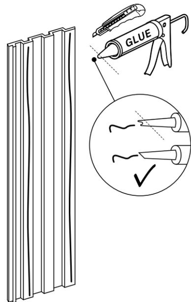
Aplicar adhesivo VOX en la parte trasera del panel en forma de letra „S“, después coloca el panel al muro.
