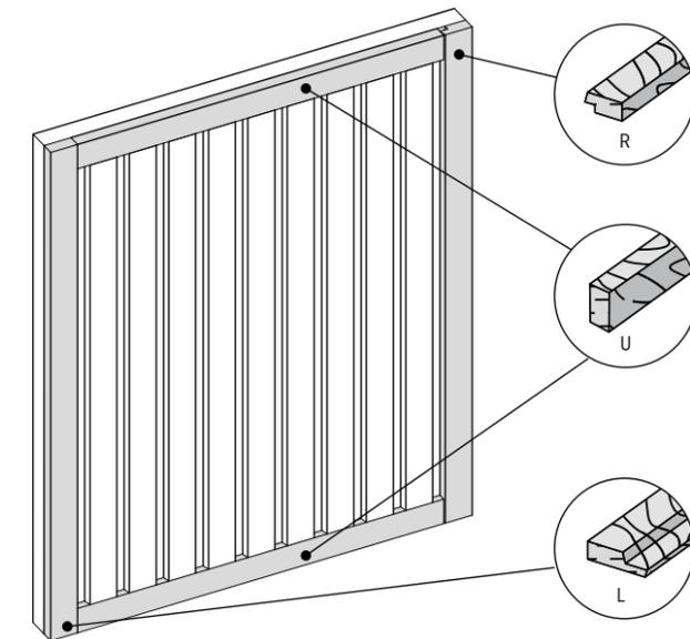
Para terminar la pared, utiliza los perfiles de acabado del sistema, que, como los paneles, se montan con adhesivo. Para cada uno de los tipos de panel, puedes elegir la moldura derecha y izquierda, mientras que la moldura universal te permitirá terminar la parte superior y parte inferior de la pared.
